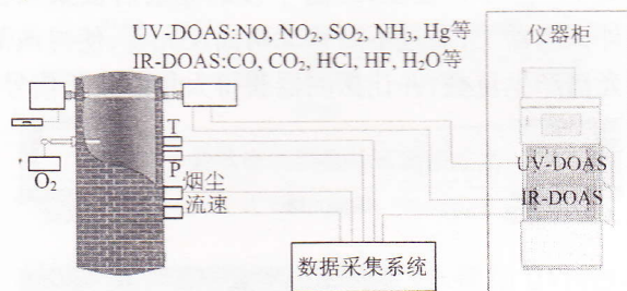
图7 垃圾焚烧厂 CEMS 示意图
