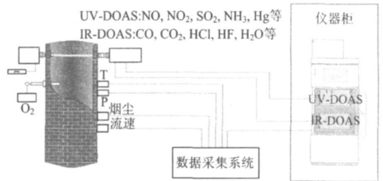
图 7 垃圾焚烧厂 CEMS 示意图
